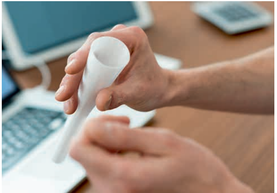
Ein im 3D-Drucker erstellter Becher aus PET. Un pavillon en PET créé par l'imprimante 3D. Un bicchiere in PET creato dalla stampante 3D.
